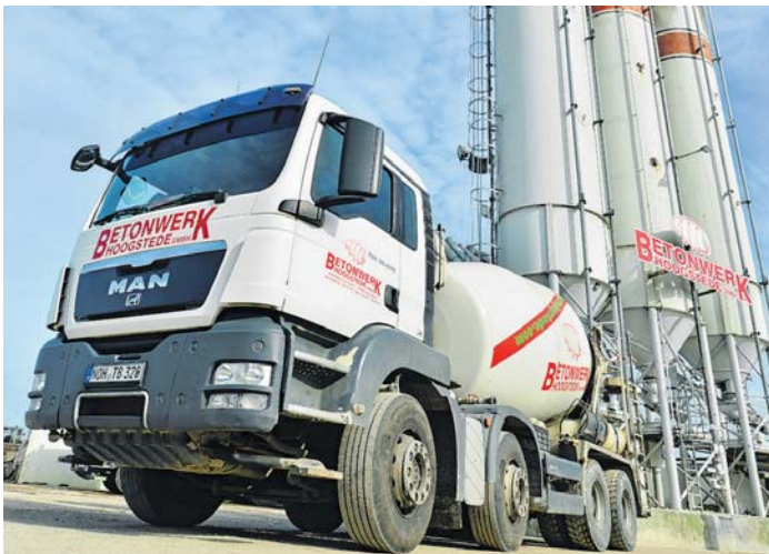
Ein Betonmischer wird an der Mischanlage beladen.
