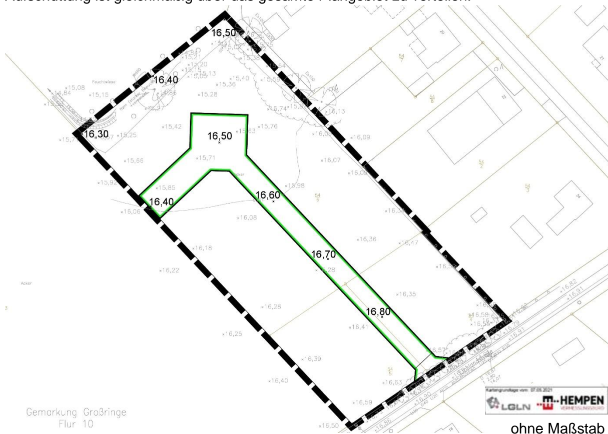
Abbildung 5: Skizze zur geplanten Höhenlage der Planstraße
